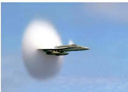
Figura 1: l'aereo oltrepassa la barriera del suono e crea un onda d'urto
